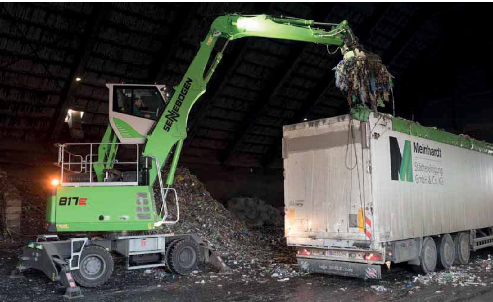
817 M – with original SENNEBOGEN sorting grab – loading of truck, indoor; Germany 817 M – mit original SENNEBOGEN Sortiergreifer– LKW Beladung in der Halle; Deutschland
