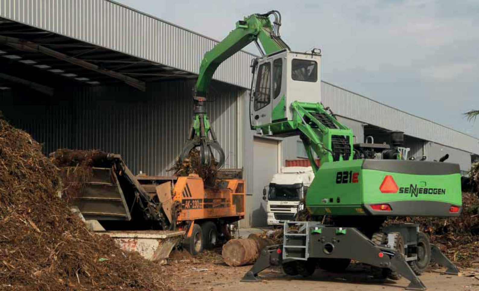
821 M – with original SENNEBOGEN orange peel grab – feeding a shredder with waste wood; Portugal 821 M – mit original SENNEBOGEN Mehrschalengreifer – Beschickung Shredder mit Altholz; Portugal
