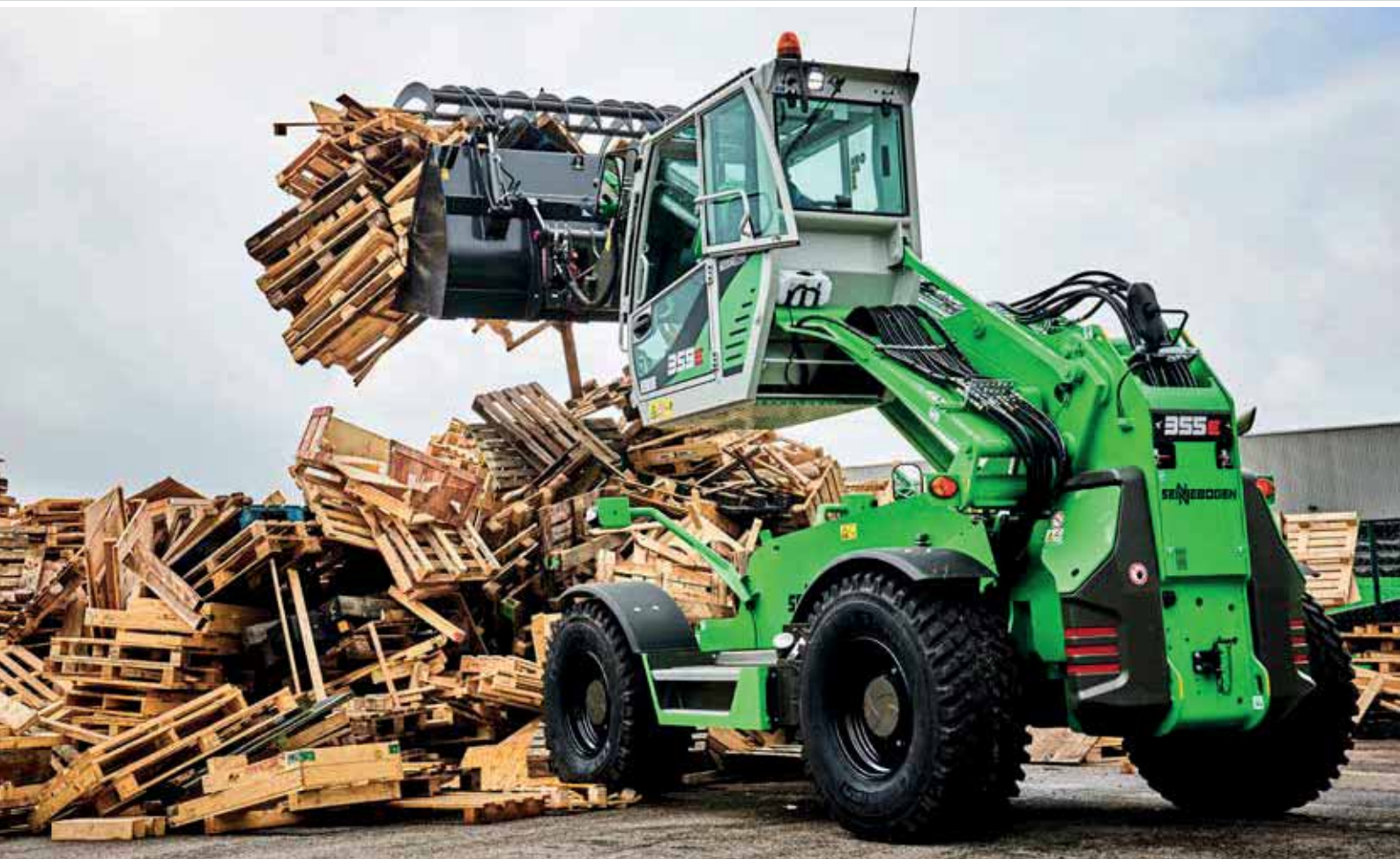
355 E Telehandler – handling of waste wood with bucket; Germany 355 E Teleskoplader – Materialumschlag von Altholz; Deutschland
