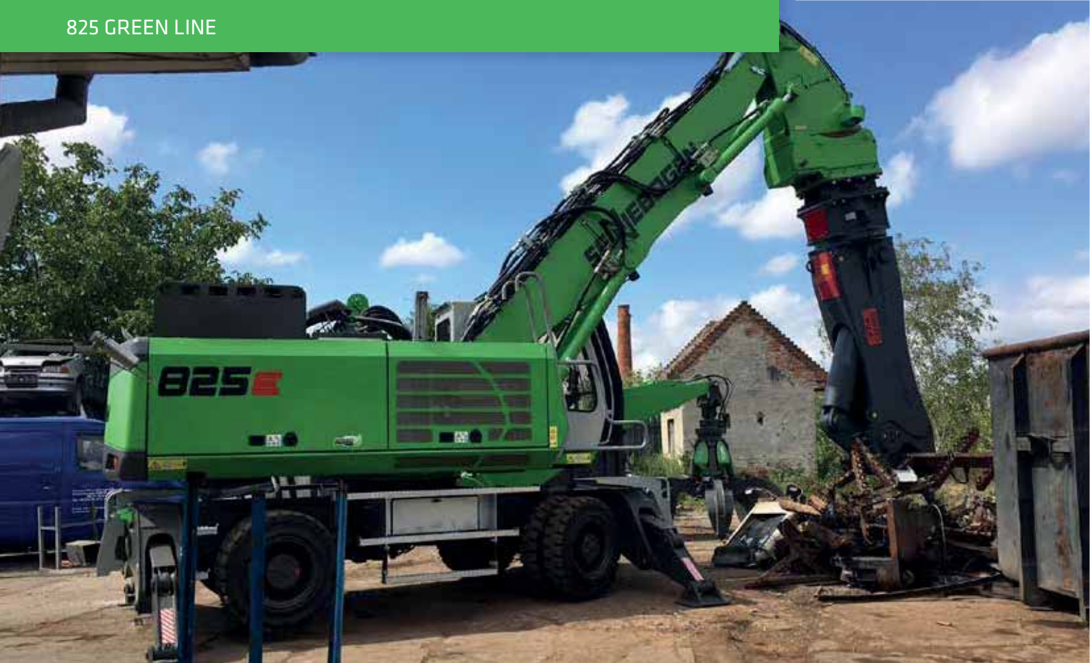
825 M – vario tool with scrap shear and orange peel grab – scrap handling; Hungary 825 M – Vario Tool mit Schrottschere und Mehrschalengreifer – Schrottumschlag; Ungarn
