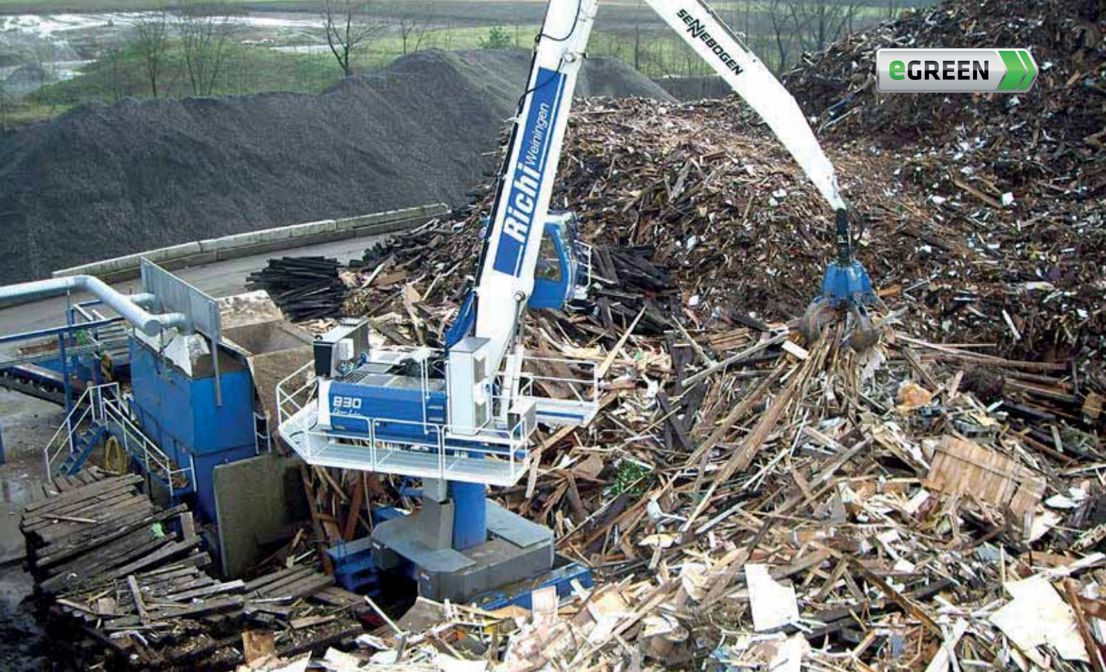
830 Electro stationary – with orange peel grab – recycling of waste wood; Switzerland 830 Elektro stationär – mit Mehrschalengreifer – Altholzrecycling; Schweiz
