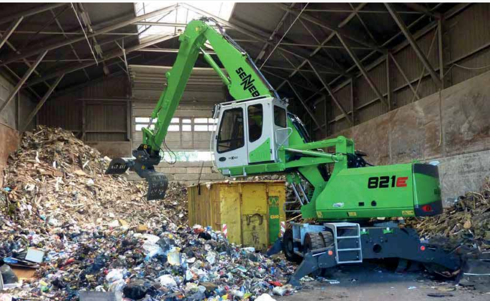
821 M – with sorting grab – sorting of waste, indoor; Netherlands 821 M – mit Sortiergreifer – Sortieren von Abfall in der Halle; Niederlande
