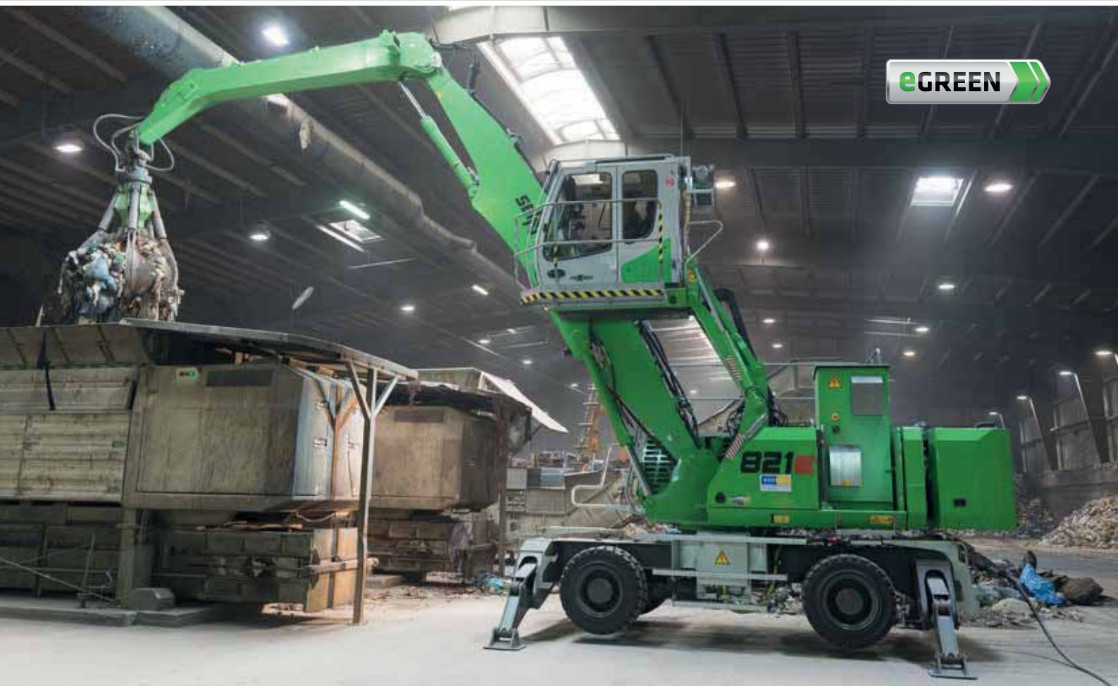
821 M Electro – with orange peel grab – feeding a shredder; Germany 821 M Elektro – mit Mehrschalengreifer – Shredderbeschickung; Deutschland
