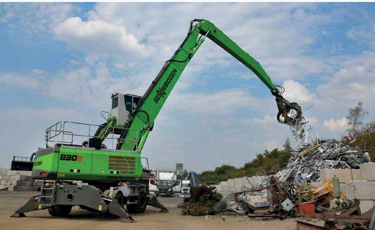
830 M – scrap handling with orange peel grab; UK 830 M – Schrottumschlag mit Mehrschalengreifer; Großbritannien
