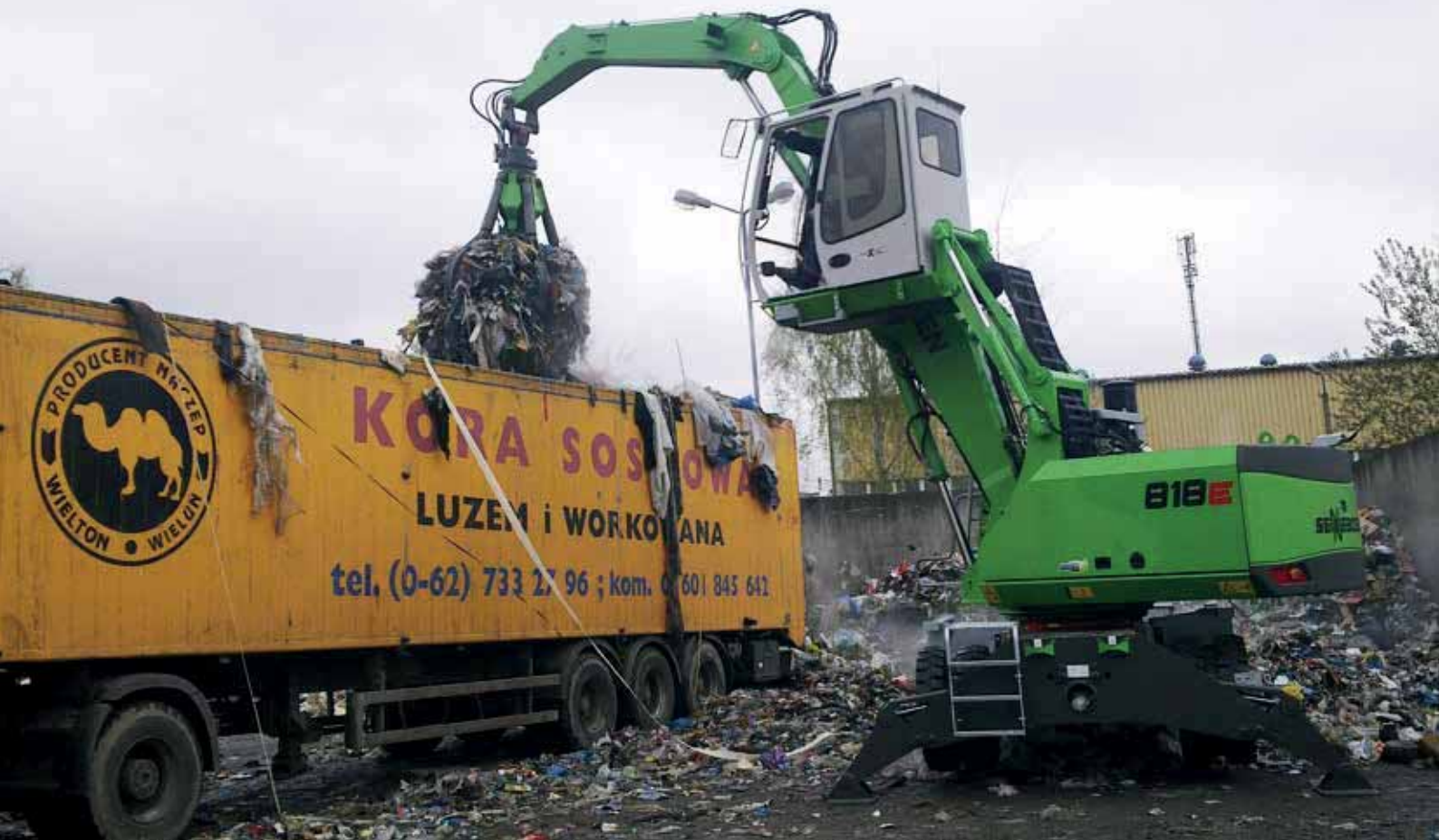
818 M – with original SENNEBOGEN orange peel grab – loading of a truck with garbage; Poland 818 M – mit original SENNEBOGEN Mehrschalengreifer – LKW-Beladung mit Industriemüll; Polen
