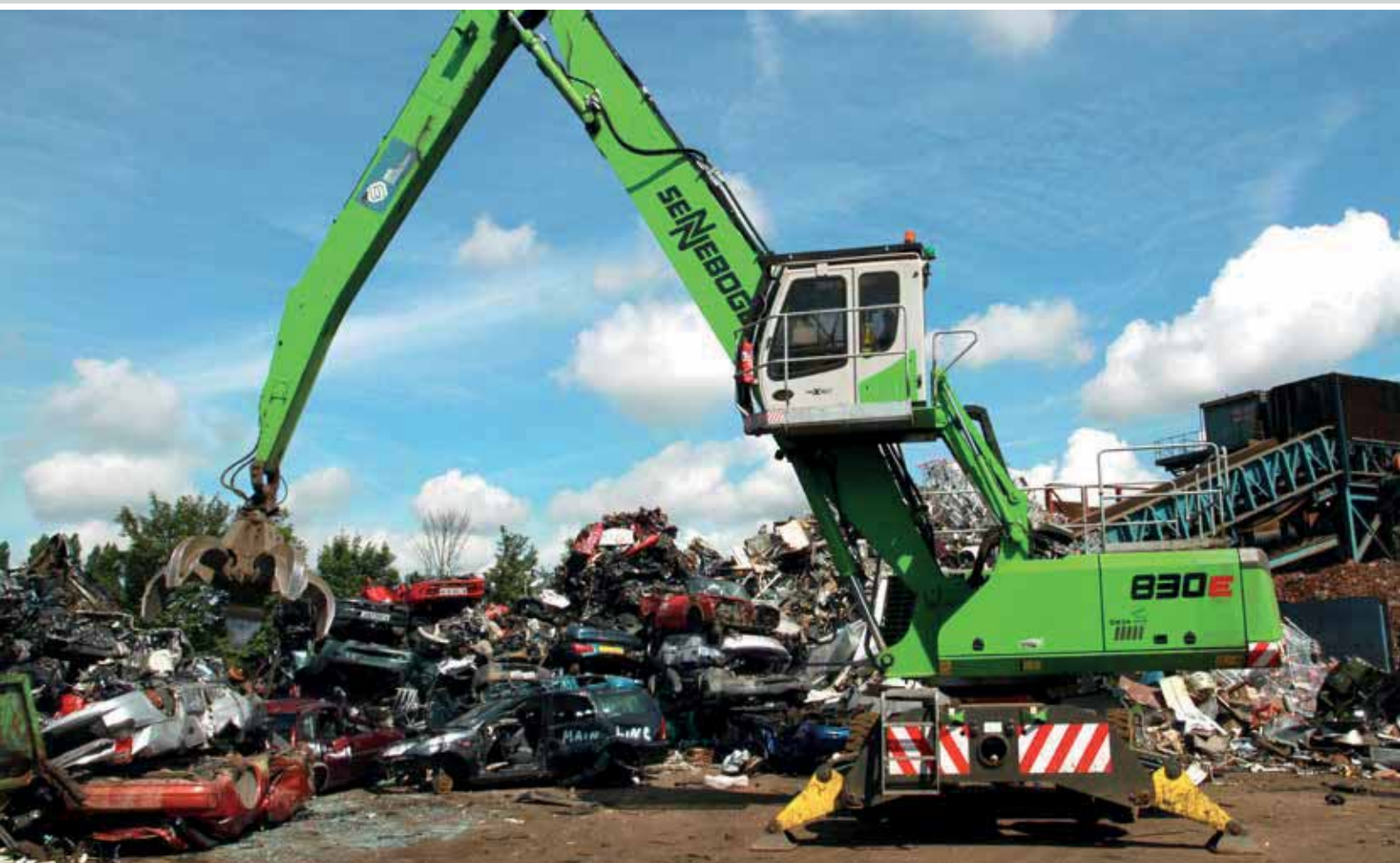
830 M – with orange peel grab – car recycling; Great Britain 830 M – mit Mehrschalengreifer – Autorecycling; Großbritannien
