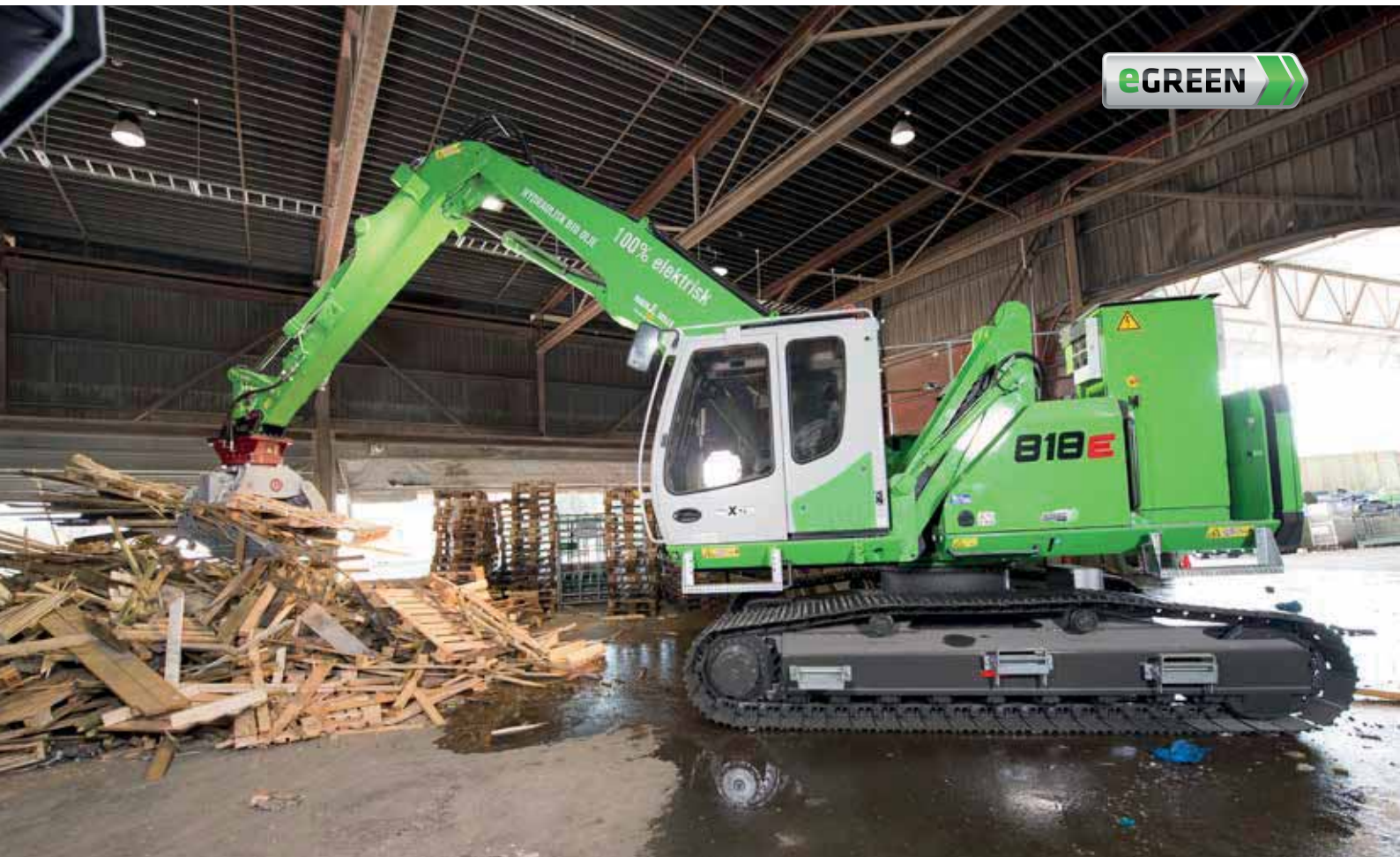
818 R Electro– with sorting grab – handling of waste wood; Norway 818 R Elektro – mit Sortiergreifer – Materialumschlag Altholz; Norwegen
