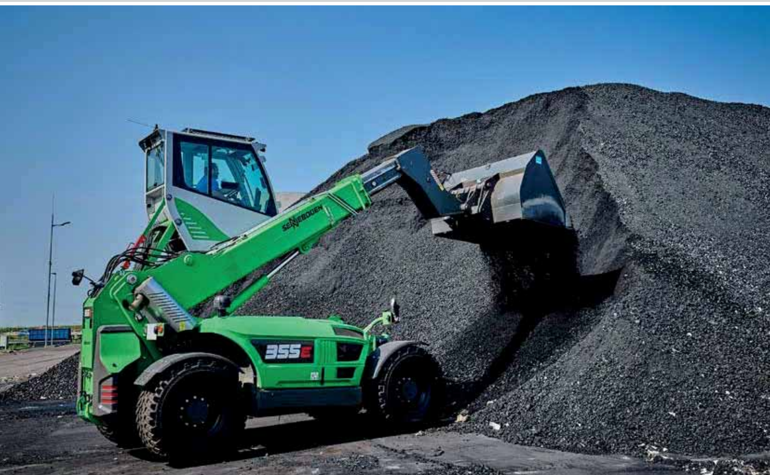
355 E Telehandler – The Z-kinematics ensures high breakaway forces in shovel operations when handling coal; Hungary 355 E Teleskoplader – Die Z-Kinematik sorgt für hohe Losbrechkräfte im Schaufeleinsatz beim Umschlag von Kohle; Ungarn
