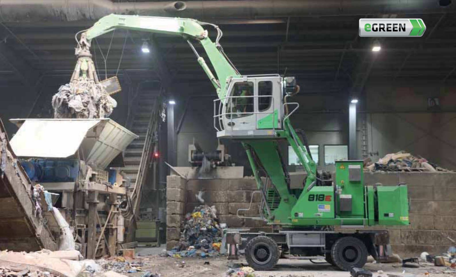
818 M Elektro – with sorting grab – loading of shredder indoor - machine with powerpack solution; Germany 818 M Elektro – mit Sortiergreifer – Schredderbeladung in der Halle - Maschine mit Powerpack-Lösung; Deutschland
