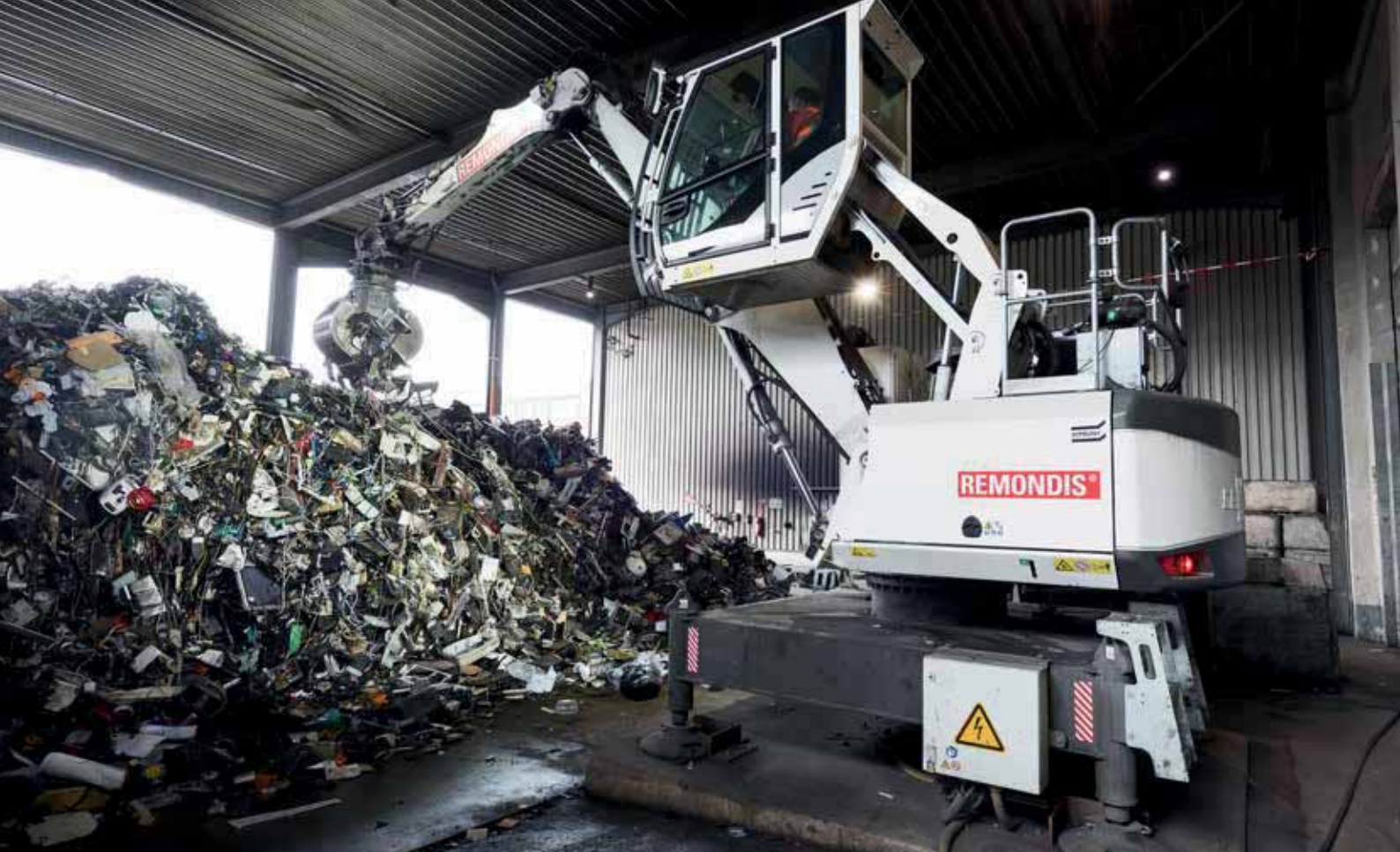
817 Electro - Efficient recycling and zero emissions thanks to stationary electrohydraulic drive; Germany 817 Elektro - effizientes Recycling und 0 Emissionen dank stationärer, elektrohydraulischer Lösung; Deutschland
