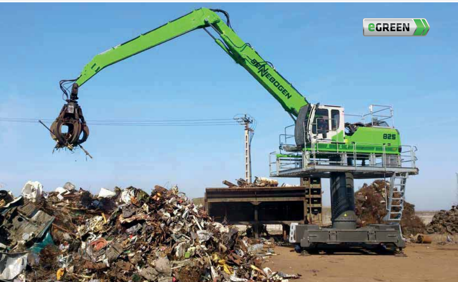
825 M – vario tool with scrap shear and orange peel grab – scrap handling; Hungary 825 M – Vario Tool mit Schrottschere und Mehrschalengreifer – Schrottumschlag; Ungarn
