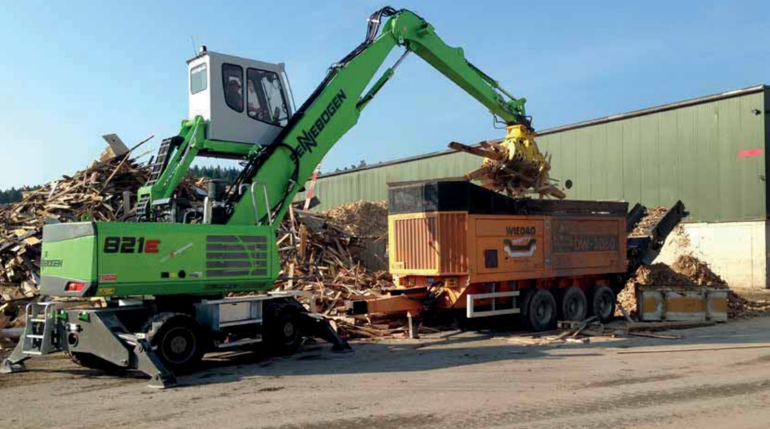
821 M – with sorting grab – feeding a shredder with waste wood; Switzerland 821 M – mit Sortiergreifer – Shredderbeschickung mit Altholz; Schweiz
