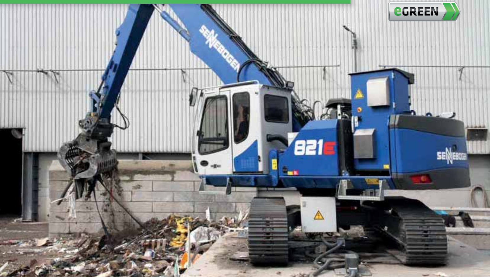
821 R Electro – with sorting grab – bulky waste; Netherlands 821 R Elektro – mit Sortiergreifer – Sperrmüllsortierung; Niederlande
