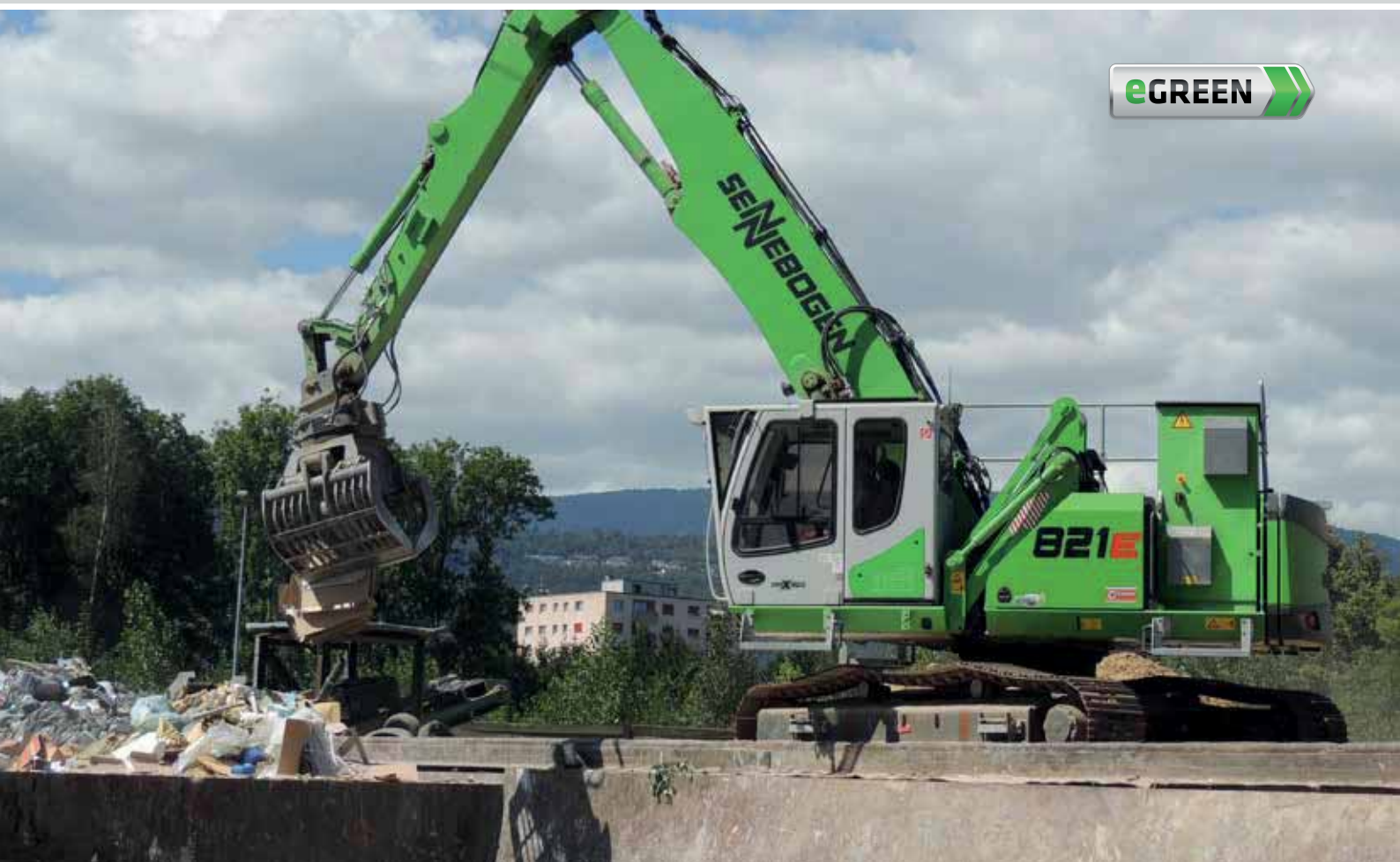
821 R Electro – with sorting grab – sorting of bulky waste outdoor; Switzerland 821 R Elektro – mit Sortiergreifer – Sortierung von Sperrmüll; Schweiz
