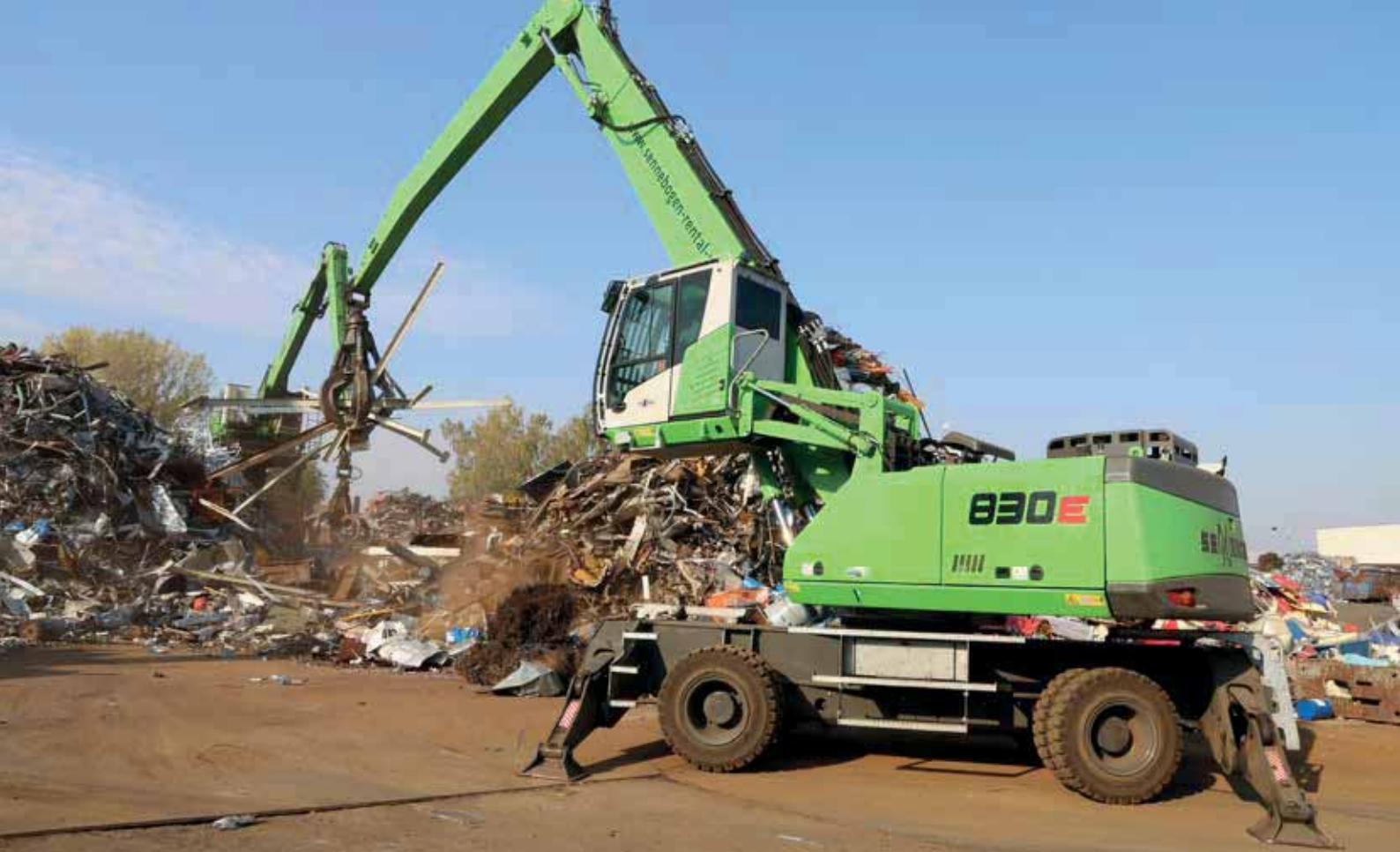
830 M – with orange peel grab – scrap handling; Germany 830 M – mit Mehrschalengreifer – Schrottumschlag; Deutschland
