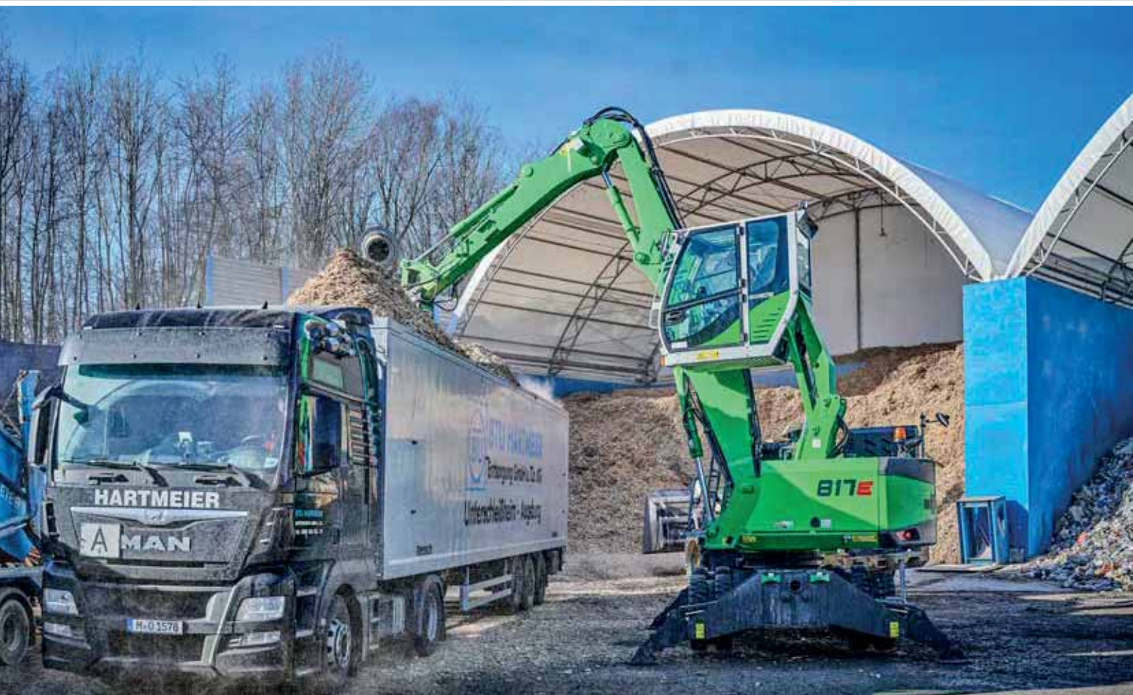
817 M – loading of a truck at the ideal viewing height with SENNEBOGEN sorting grab; Germany 817 M – Beladung eines LKW auf idealer Sichthöhe mit SENNEBOGEN Sortiergreifer; Deutschland
