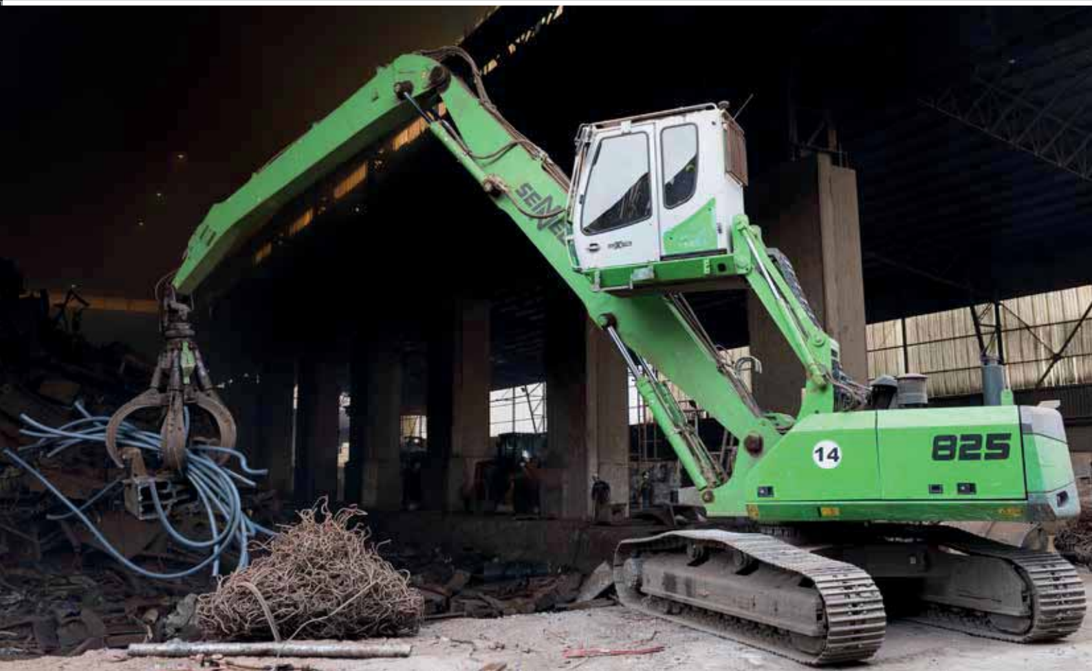
825 M – with orange peel grab – scrap handling, indoor; Turkey 825 M – mit Mehrschalengreifer – Schrottumschlag in der Halle; Türkei
