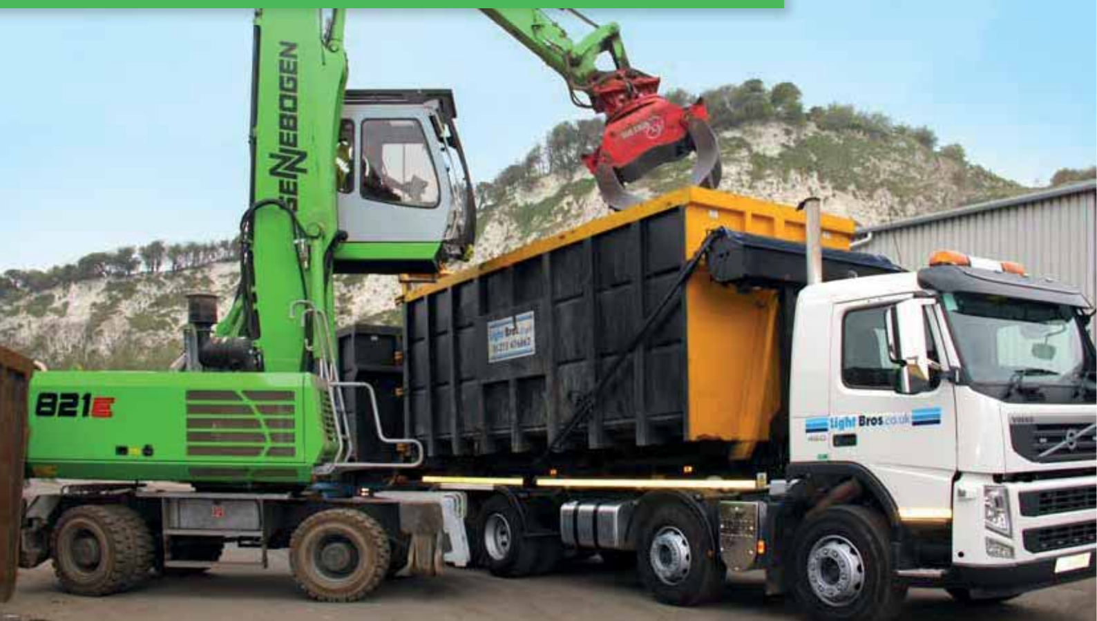
821 M – with sorting grab – truck loading with scrap; Great Britain 821 M – mit Sortiergreifer – LKW-Beladung mit Schrott; Großbritannien
