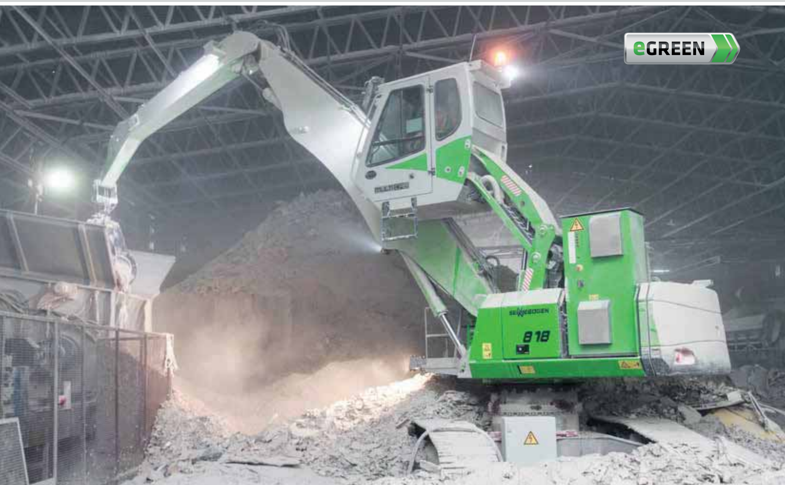
818 R – tracked version, indoor recycling; USA 818 R – Raupersion beim Recycling in einer Halle; USA
