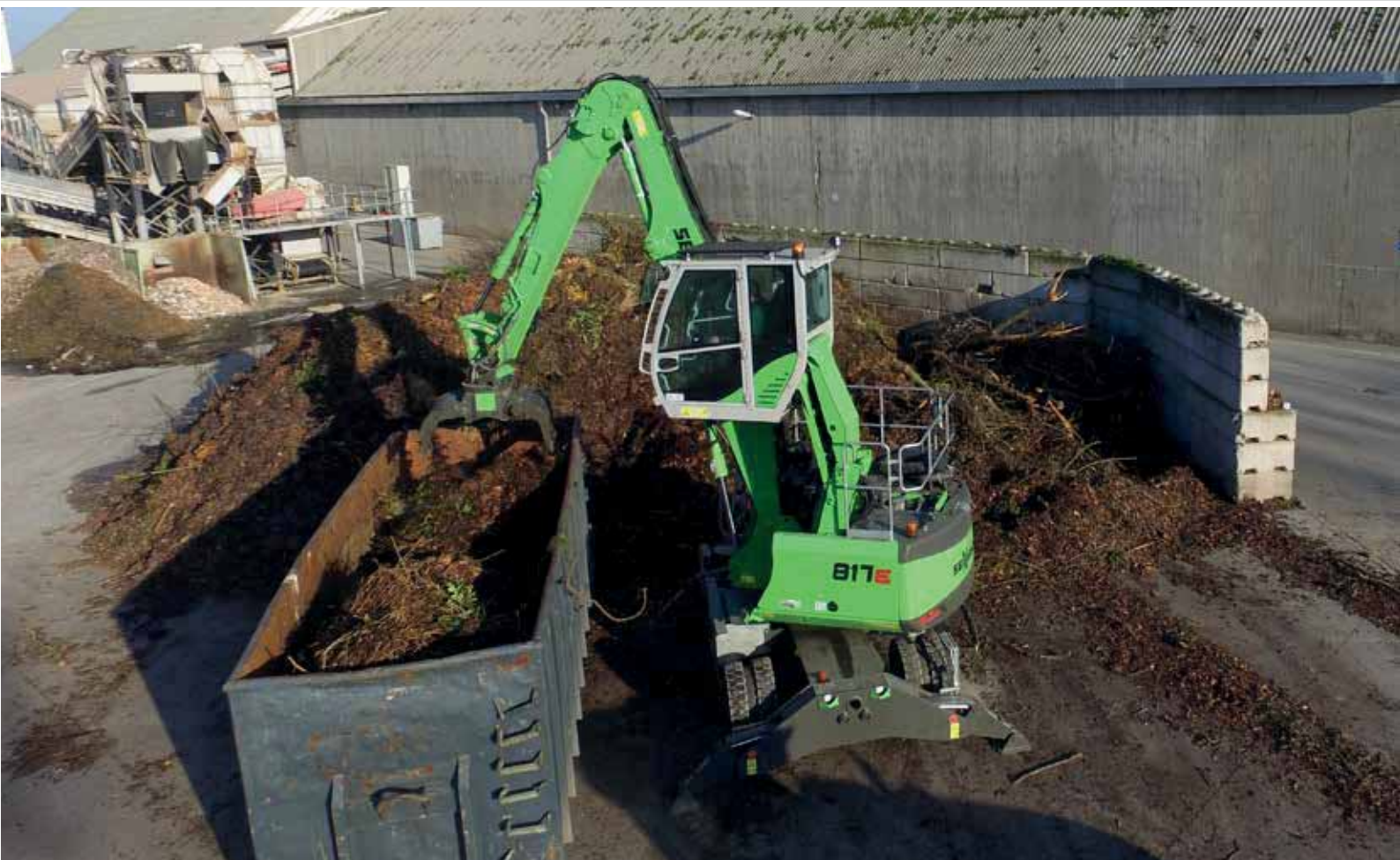
817 M - with original SENNEBOGEN sorting grab - container loading outdoor; Germany 817 M - mit original SENNEBOGEN Sortiergreifer- Container Beladung im Freien; Deutschland
