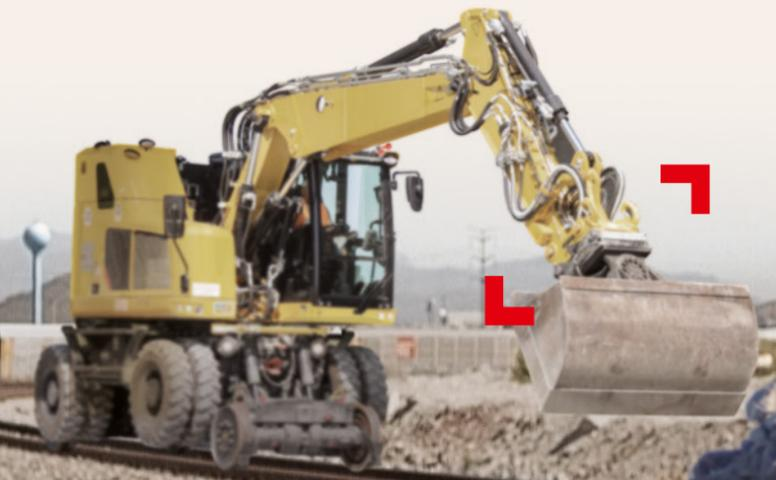
»Durch den hohen Zeitdruck, bei teilweise laufendem Zugbetrieb auf Gleisbaustellen, müssen Anbaugeräte an unseren Zweiwegelbaggern sehr schnell und einfach gewechselt werden können.«
