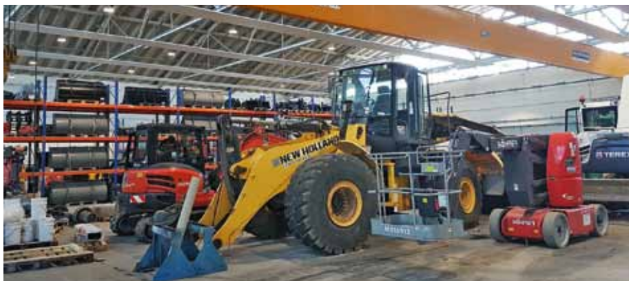
Blick in die Werkstatt am Standort Erlensee (Südhausen): Neben einem Deckenkran stehen den Monteuren Hubsteiger zur Verfügung. Somit kann auch an Großmaschinen bequem gearbeitet werden.
