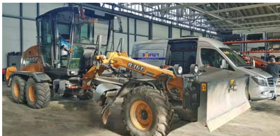
Eine besondere Serviceleistung stellt der Steuerungsumbau von Hebel- auf Joystickbedienung bei Gradern dar. Dadurch sei die Maschine komfortabler bedienbar und diene somit der Fahrerentlastung.
